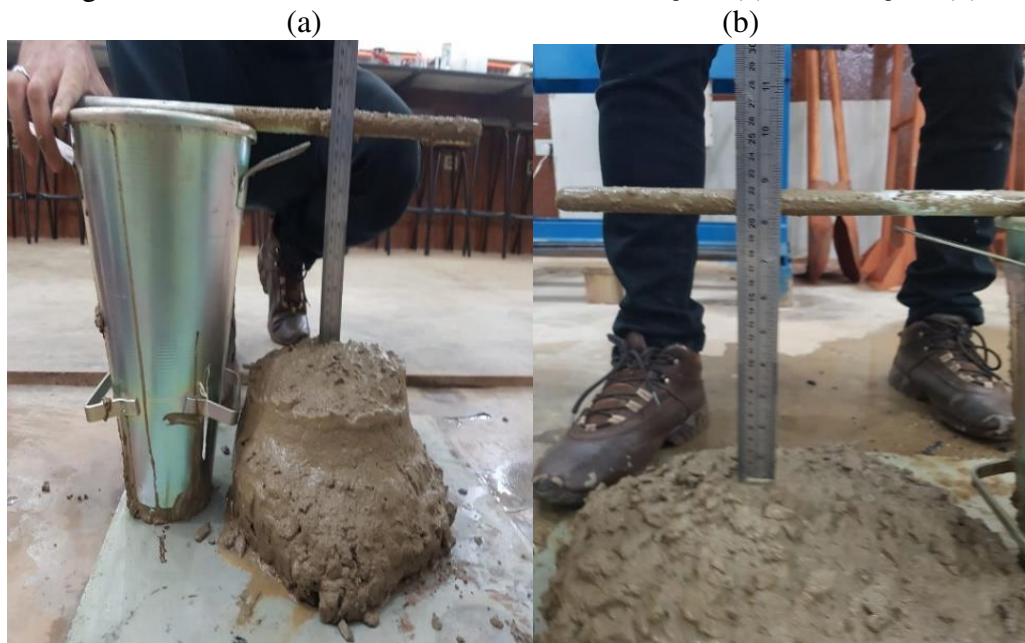
Figura 9 - Abatimento do tronco de cone do Traço 1 (a) e do Traço 2 (b).
