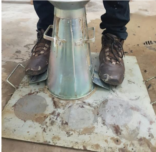
Figura 5 - Posicionamento para preenchimento do molde.
