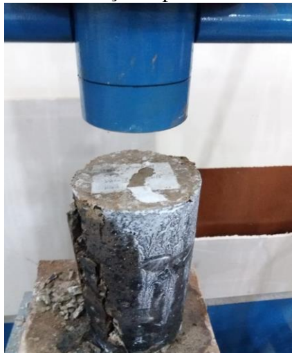
Figura 27 - CP4 do Traço 2 após ensaio de compressão.
