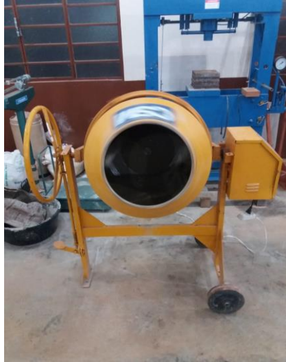
Figura 3 - Imprimação da betoneira.
