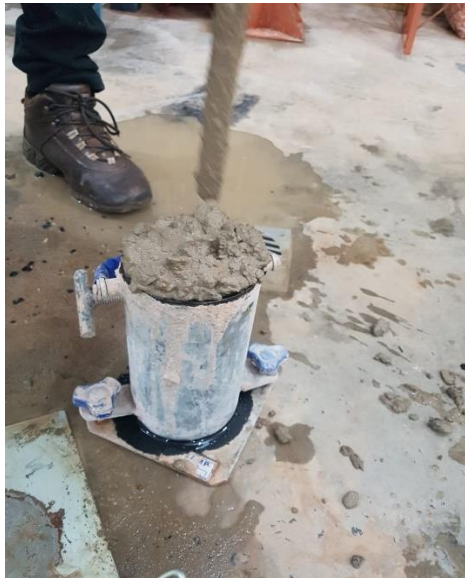
Figura 13 - Adensamento da última camada com excesso de concreto.
