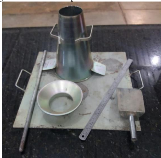
Figura 4 - Materiais para ensaio de abatimento.
