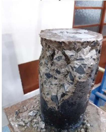
Figura 26 - CP3 do Traço 2 após ensaio de compressão.
