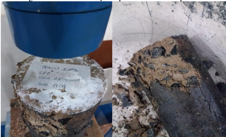
Figura 21 - CP2 do Traço 1 após ensaio de compressão.
