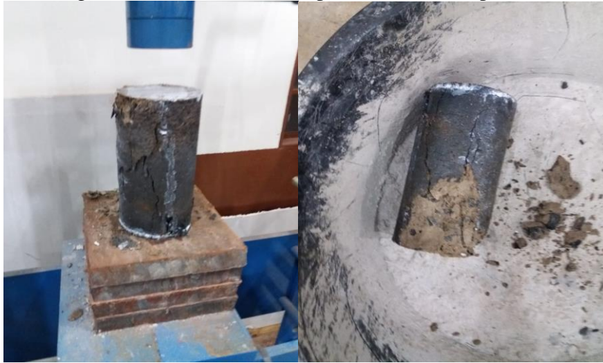
Figura 20 - CP1 do Traço 1 após ensaio de compressão.
