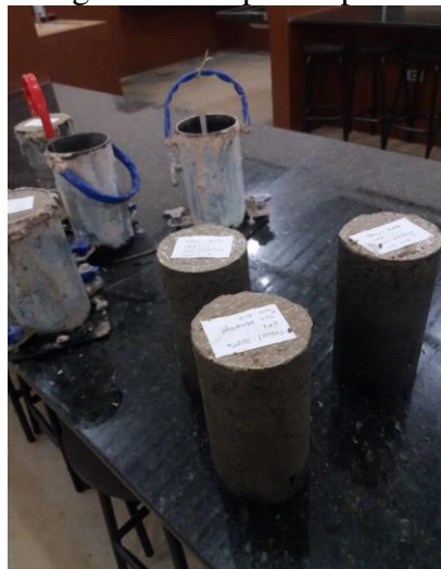
Figura 16 - Desmoldagem dos corpos de prova após a cura inicial.
