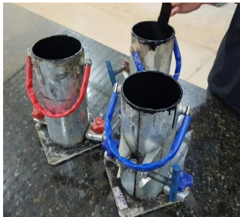
Figura 2 - Molde revestido internamente com desmoldante.
