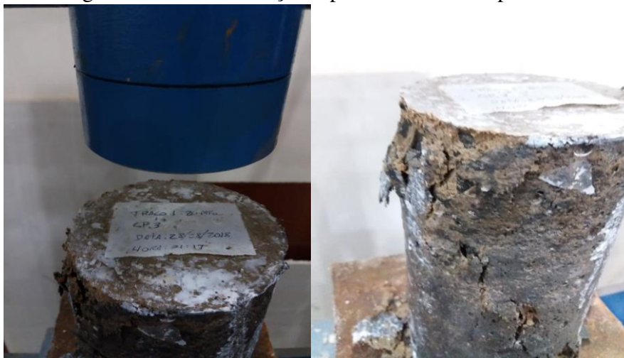
Figura 22 - CP3 do Traço 1 após ensaio de compressão.
