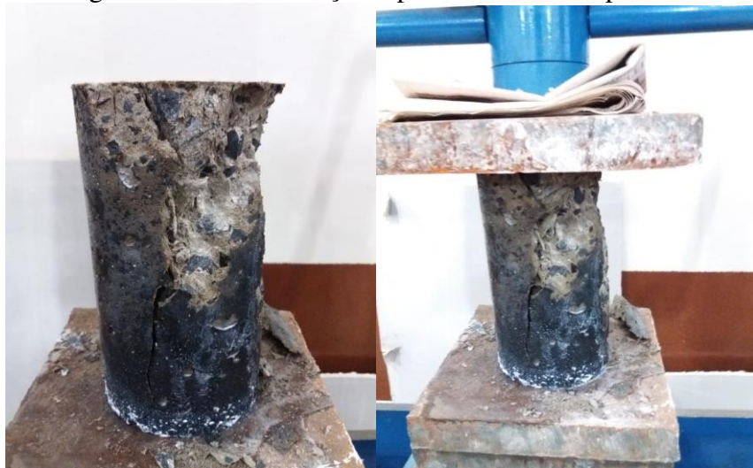
Figura 24 - CP1 do Traço 2 após ensaio de compressão.
