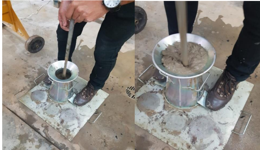
Figura 7 - Adensamento com haste de socamento.
