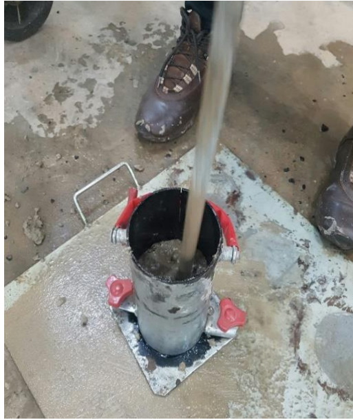
Figura 11 - Nivelando o concreto com a haste antes do adensamento.
