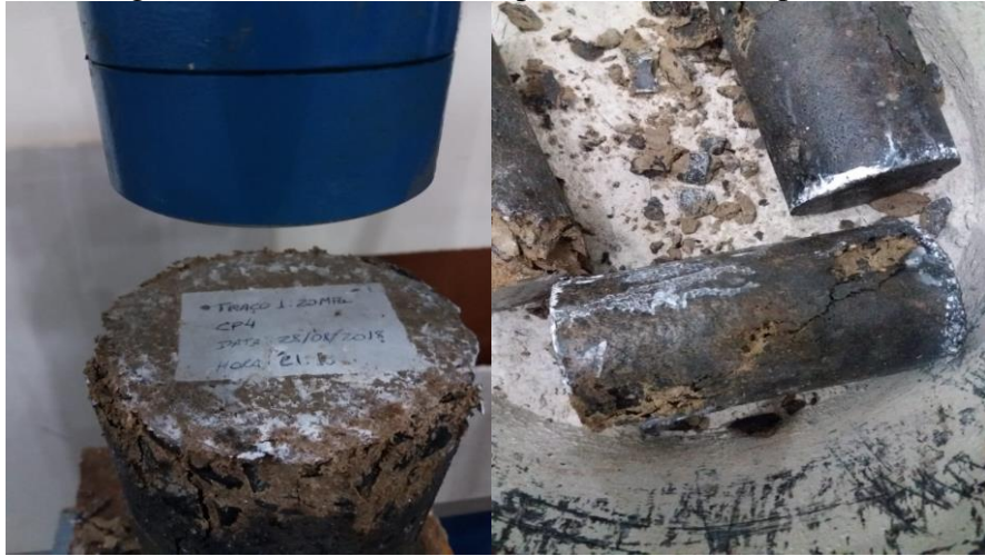
Figura 23 - CP4 do Traço 1 após ensaio de compressão.
