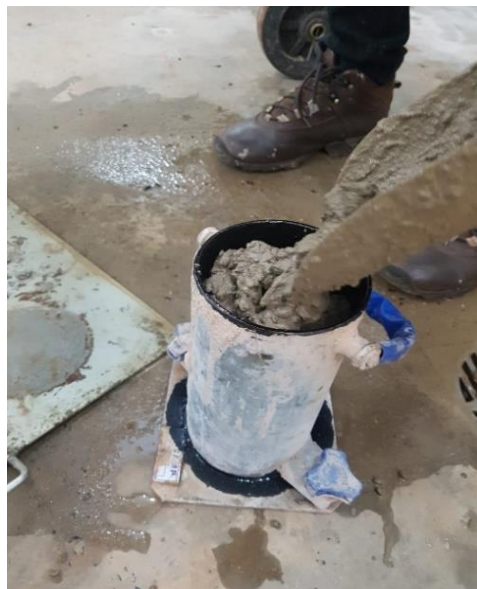
Figura 10 - Adição do concreto no molde utilizando concha com seção U.
