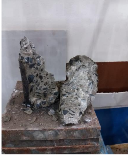
Figura 25 - CP2 do Traço 2 após ensaio de compressão.
