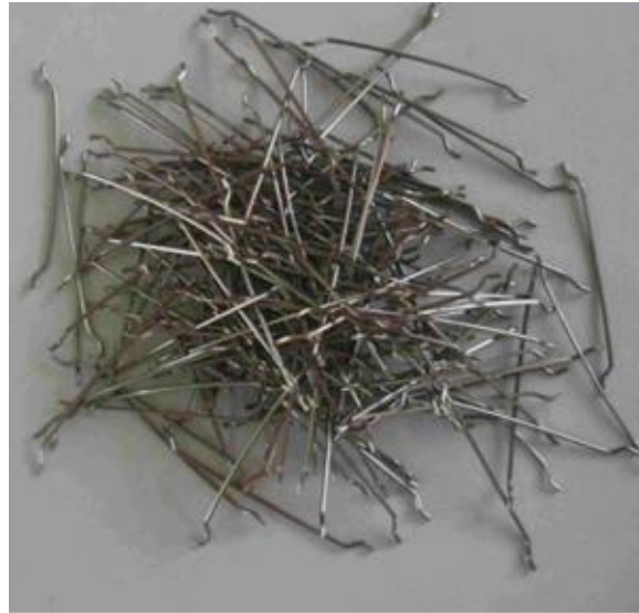
Figura 3 – Fibras de aço com ancoragem na extremidade
