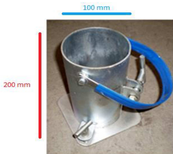
Figura 3 – Molde para corpo de prova de concreto
