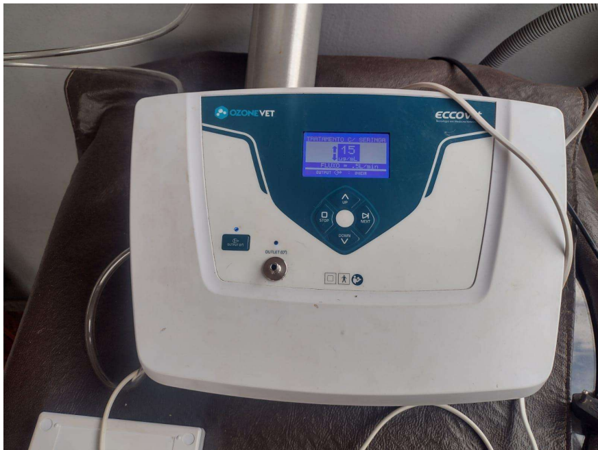
Figura 1 - Equipamento gerador de ozônio
