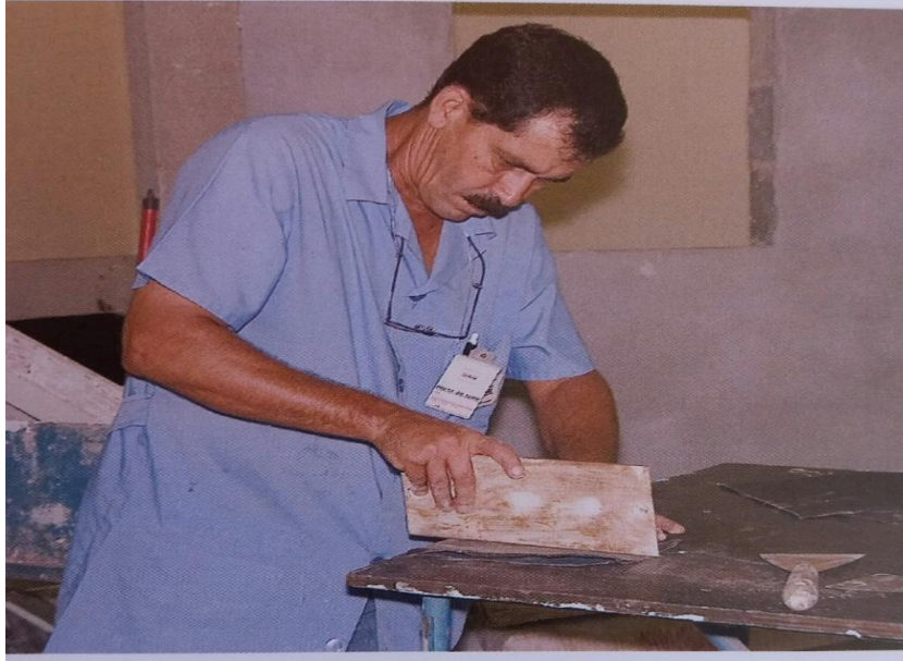
Figura 12 - Lixagem das bordas da desempenadeira de aço para eliminar ferrugem
